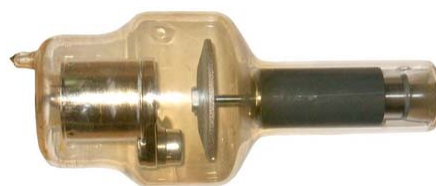
Forgóanódos röntgenső (anód forgás hűtés végett)
