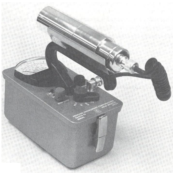
GM csöves felületi szennyezettségmérő
