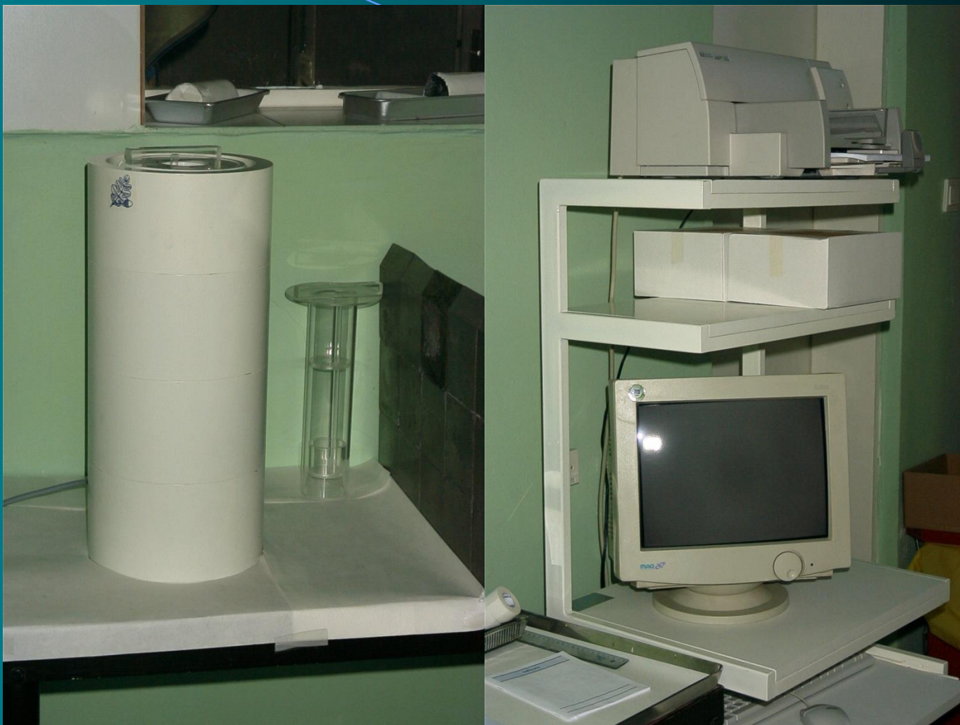
Ionizációs Kamra Dóziskalibrátor /Veenstra 405/ számítógépes támogatással /kalibrált/
