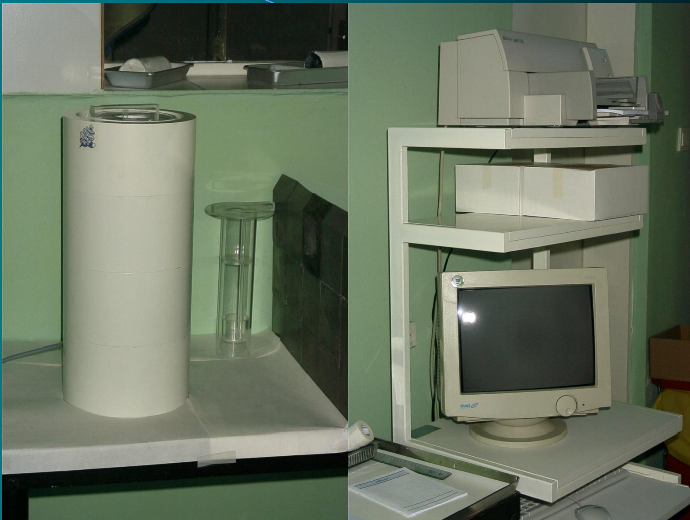
Ionizációs Kamra Dóziskalibrátor /Veenstra 405/ számítógépes támogatással /kalibrált/
