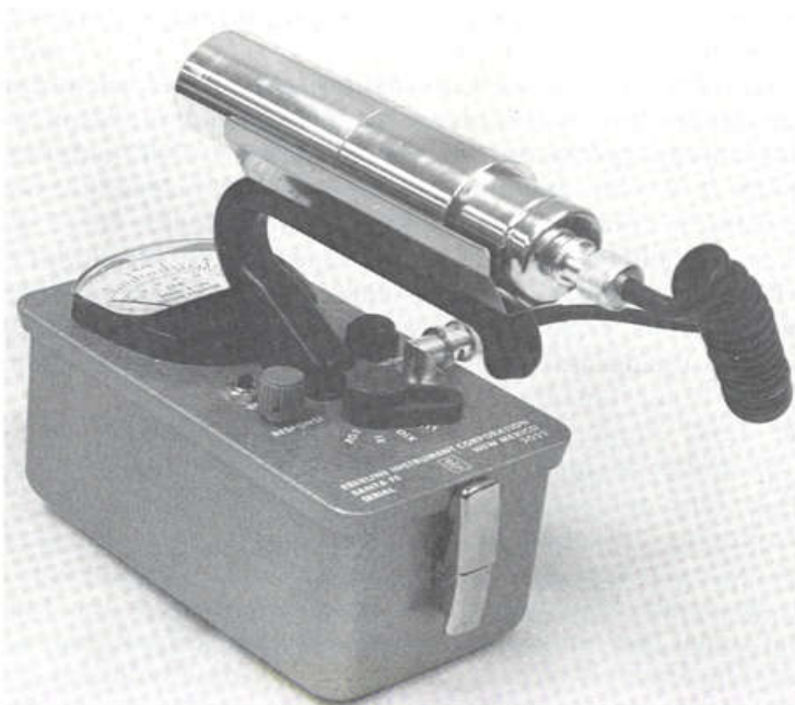
GM Detektor Alapú Felületi Szennyezettségmérő
