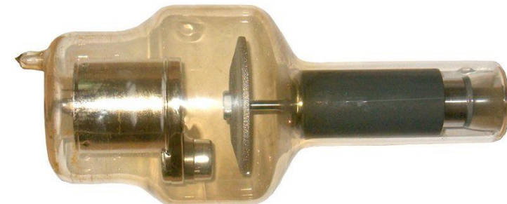
Forgóanódos röntgencső (anód forgás hűtés végett)
