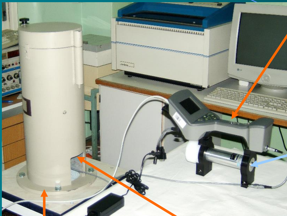
Ólomtorony NaI(Tl) detektor
