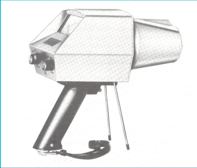
Ionizációs kamra alapú szennyezettség mérő
