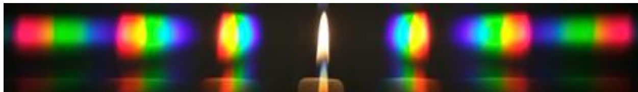
Nebenmaximum 2-ter Ordnung Nebenmaximum 1-ter Ordnung Hauptmaximum Nebenmaximum 1-ter Ordnung Nebenmaximum 2-ter Ordnung
