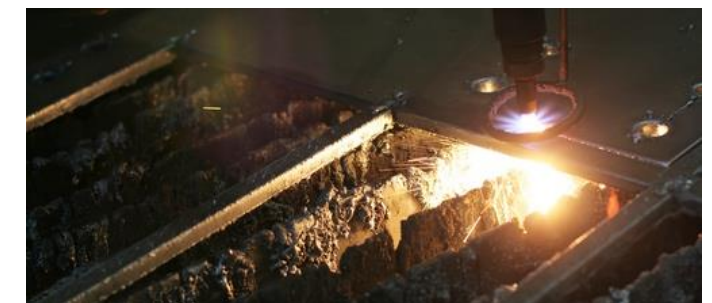
fémleap vágása CO 2 lézerrel
