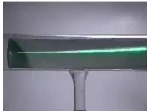
Kathodenstrahl (Elektronenstrahl) in einer Vakuumröhre
