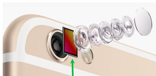
CCD mobiltelefon kamerájában
