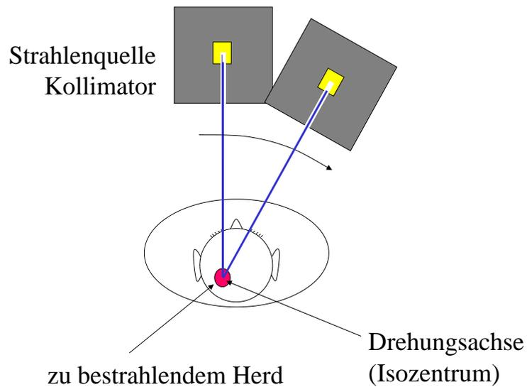
Statt Umdrehung von einer Strahlenquelle: viele Strahlenquellen (Isotope) strahlen gleichzeitig aus unterschiedlichen Richtungen auf ein kleines Zielvolumen: **Gamma-Messer (Gamma Knife)**
