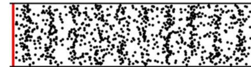
**Längswellen (longitudinale Wellen):** Verdichtungen und Verdünnungen (d.h. *Druckschwankungen gegenüber dem Normaldruck*) laufen über das Trägermedium. Die Schwingungsrichtung der einzelnen Oszillatoren ist parallel zur Ausbreitungsrichtung der Welle.
