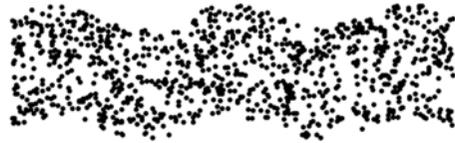
*Querwellen (transversale Wellen):* Wellenberge und Wellentäler laufen über das Trägermedium. Die Schwingungsrichtung der einzelnen Oszillatoren steht senkrecht zur Ausbreitungsrichtung der Welle.
