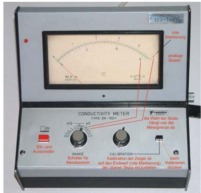
Abb. 11. Messanordnung des analogen Konduktometers und Gebrauch der Skalen
