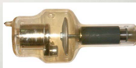
Forgóanódos röntgenső (anód forgás hűtés végett)
