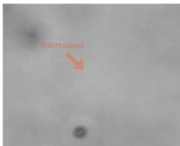
Hat folyadékban álló részecskékre (lézercsipeszben megragadott mikrogyöngy)
