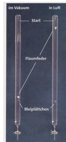
20.1 Fallröhre: Im Schwere- oder Gravitationsfeld der Erde fallen alle Körper „gleich schnell“.
