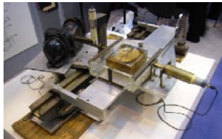
Legelső CT szkennelő prototípusa (deszkapéldány)
