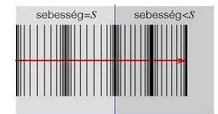
Terjedés során a frekvencia nem változik. Csökkent sebesség esetén a hullámhossz csökken.
