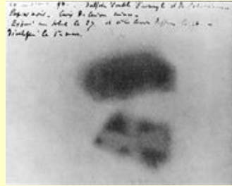
Becquerel fotolemezén az uránium só által létrehozott kép. Az uránium és a fotolemez közé helyezett máltai kereszt képe kirajzolódik. (1896)
