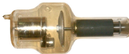
Forgóanódos röntgenső (anód forgás hűtés végett)
