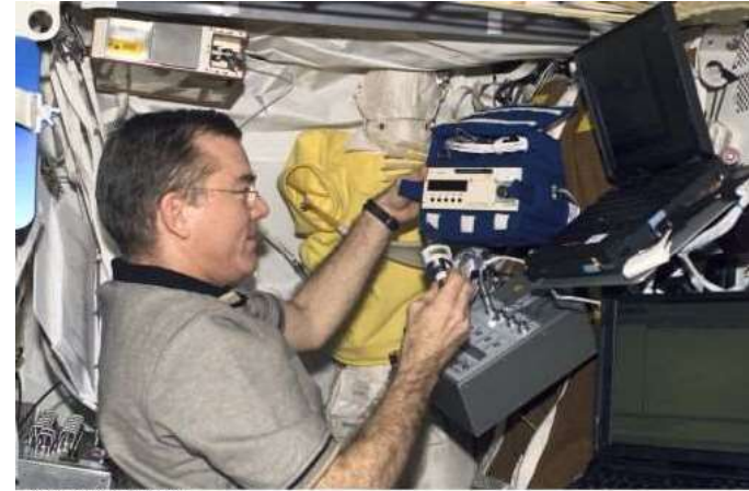
Jim Voss amerikai űrhajós a Pille kiértékelő egységébe helyezi a dózismérőt. (Fotó: NASA ISS002E7814)
