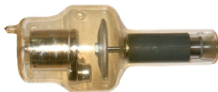
Forgóanódos röntgenső (anód forgás hűtés végett)
