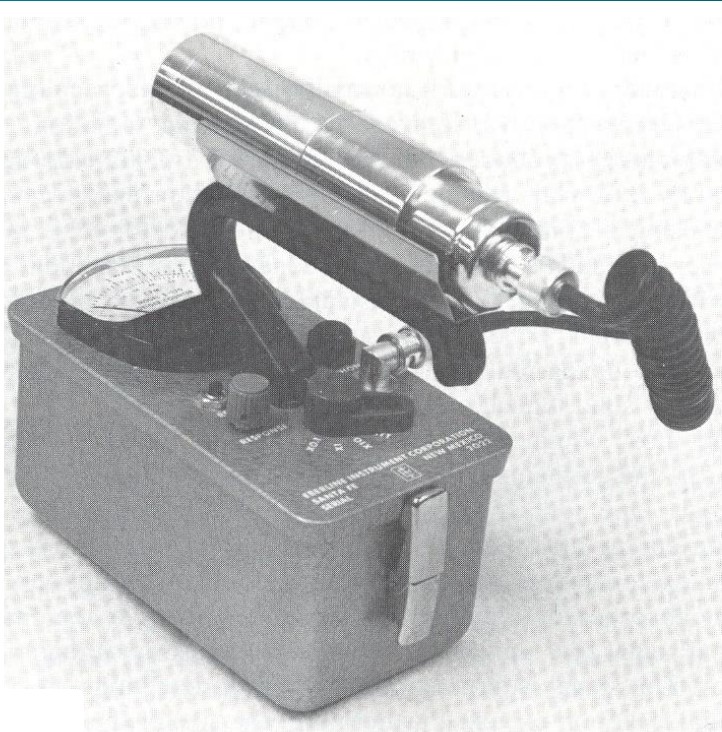
GM csöves felületi szennyezettségmérő
