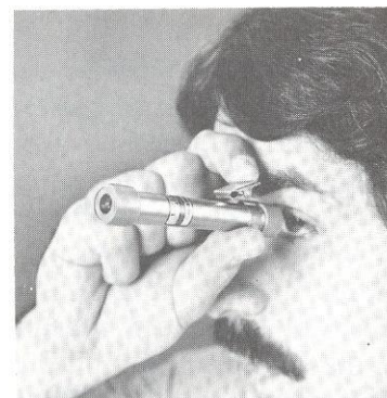
Személyi dosiméter (ionizációs kamra alapú)
