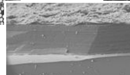
Korrosionsschicht auf einem antiken Glasstück (SEM)
