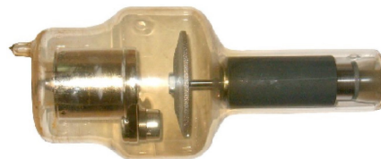
Forgóanódos röntgenső (anód forgás hűtés végett)
