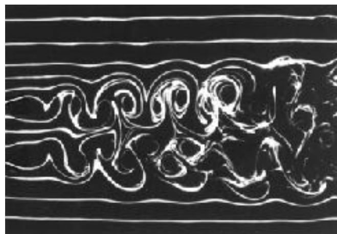
Turbulens áramlás ( R > \sim 1000 ) hangeffektussal jár
