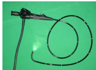
geordnete Faserbündel für die Bildübertragung (eine Art der Endoskopie)
