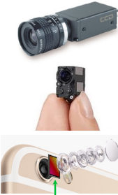
CCD mobiltelefon kamerájában
