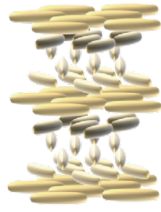
Koleszterikus állapot (nematikus rendezettség különböző síkokban; speciális eset: csavart nematikus állapot - menetemelkedés a szint befolyásolja)
