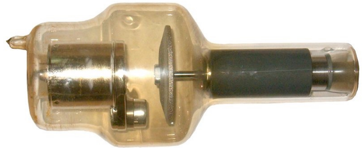
Forgóanódos röntgenső (anód forgás hűtés végett)
