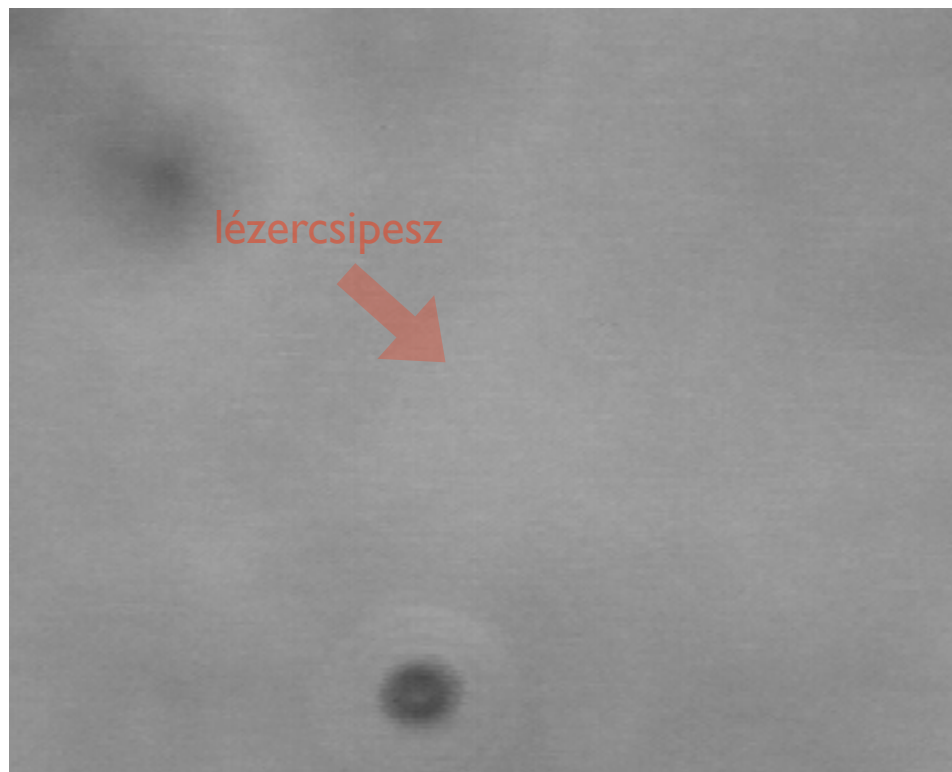
Hat folyadékban álló részecskékre (lézercsipeszben megragadott mikrogyöngy)
