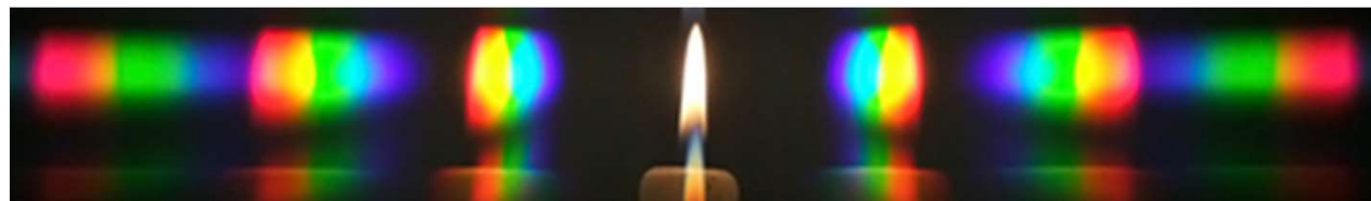
Beugung von weißem Licht an einem optischen Gitter
