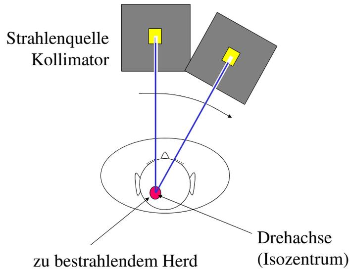
Statt Umdrehung von einer Strahlenquelle: viele Strahlenquellen (Isotope) strahlen gleichzeitig aus unterschiedlichen Richtungen auf ein kleines Zielvolumen: **Gamma-Messer (Gamma Knife)**
