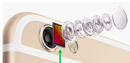
CCD mobiltelefon kamerájában
