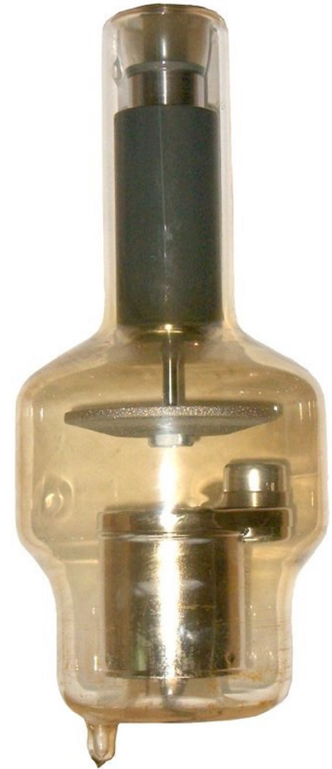
Forgóanódos röntgencső (anód forgás hűtés végett)
