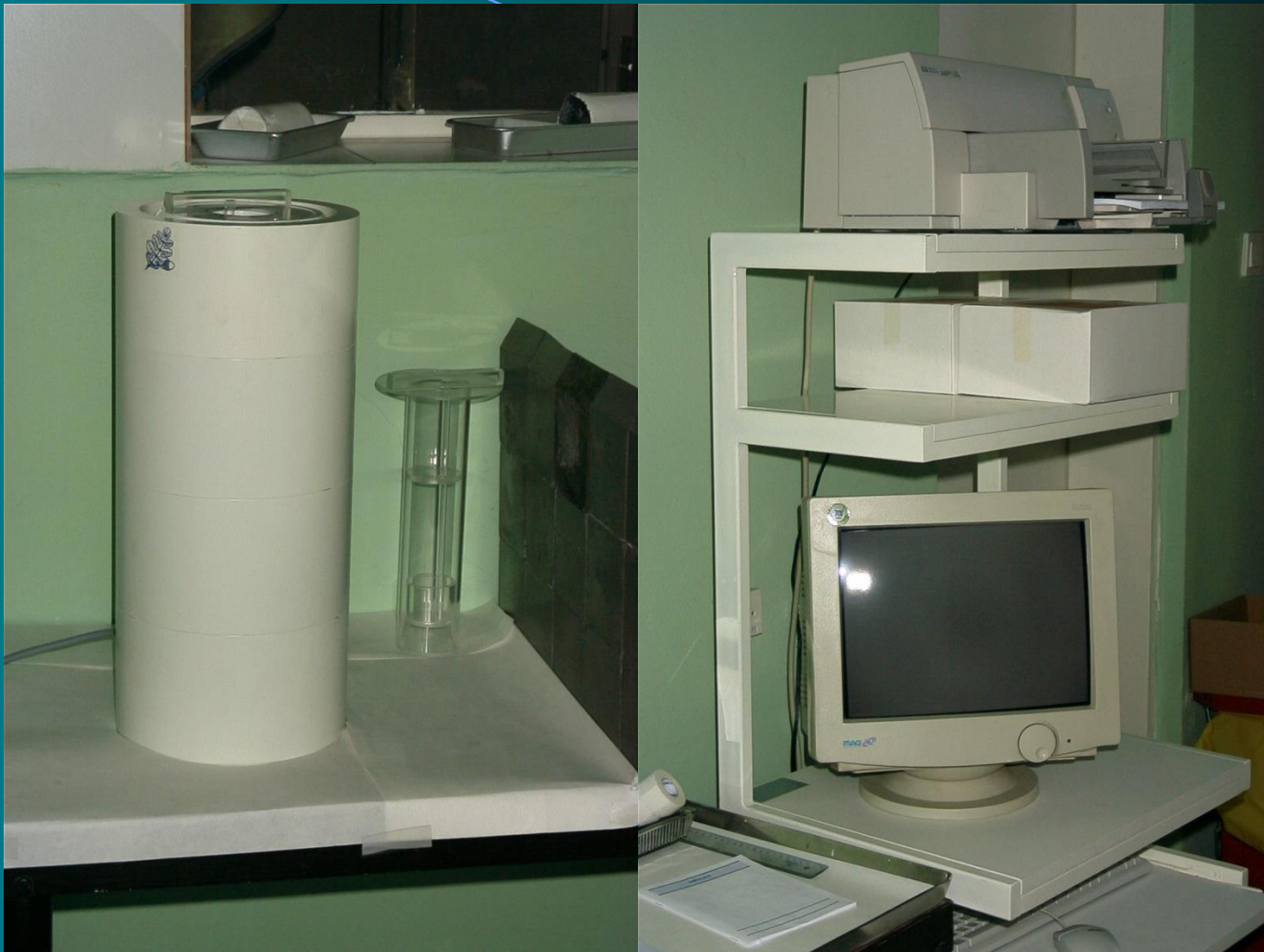
Ionizációs Kamra Dóziskalibrátor /Veenstra 405/ számítógépes támogatással /kalibrált/
