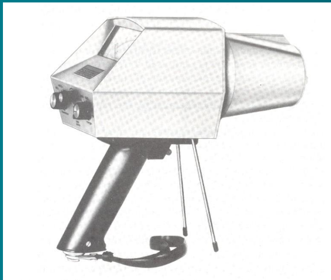
Ionizációs kamra alapú szennyezettség mérő
