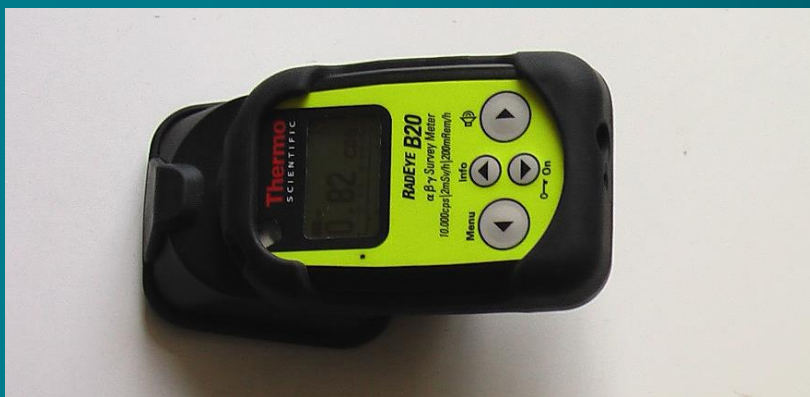
GM Detektoros felületi szennyezettségmérő (RadEye B20)
