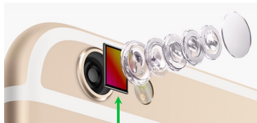
CCD mobiltelefon kamerájában
