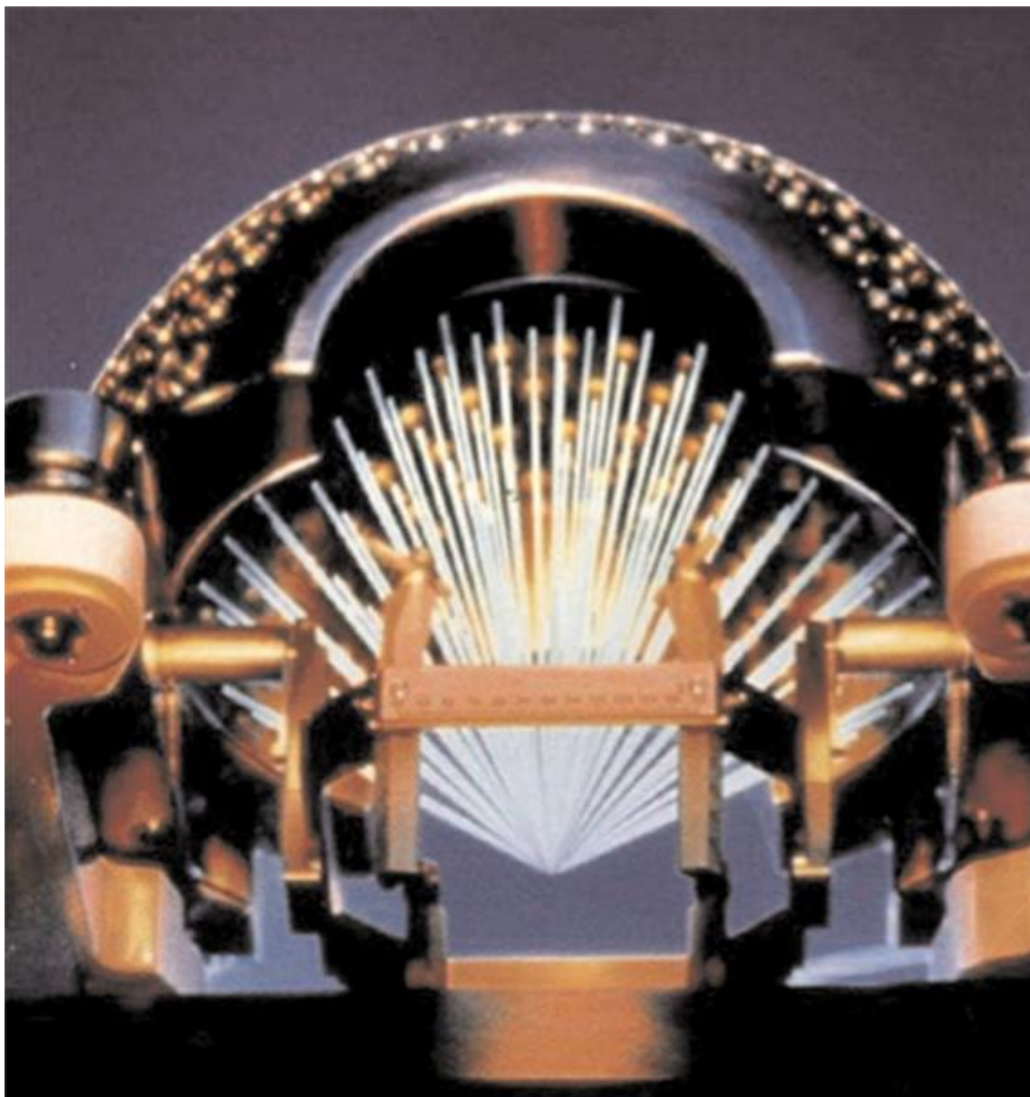
IX.21. ábra. Gamma-kés működése. Az előtérben lent látszik a páciens fejének rögzítésére szolgáló keret
